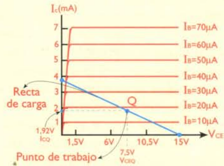
Figura 8.14c. Recta de carga y punto de trabajo con R_C=3,9k\Omega
